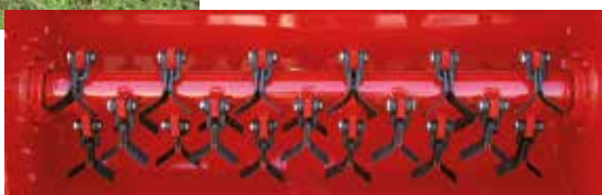
vue des outils du broyeur
