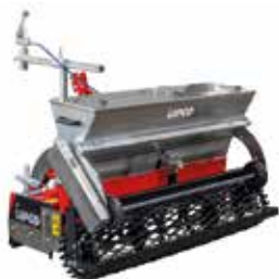
Herse Rotative UKD avec Semoir SMD (en option)
