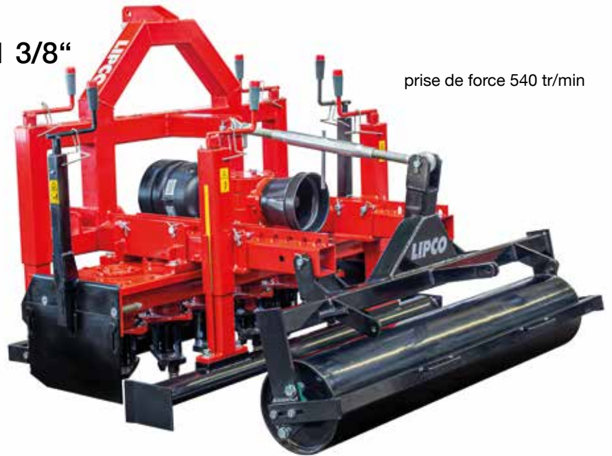
balai suiveur avec balai latéral et vis de réglage
