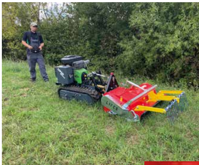
Broyeur à Fléaux MG avec effaroucheur d'insectes (en option)
