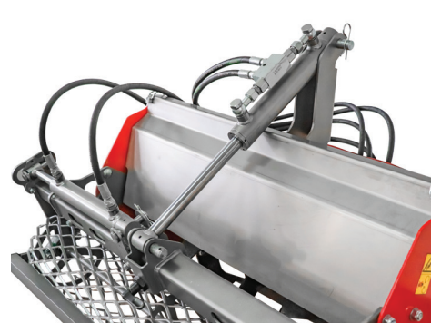
Réglage en hauteur et latéral hydraulique du rouleau suiveur en option
