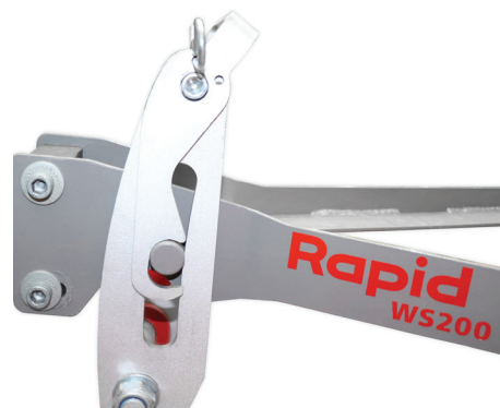
En position de transport ou de chargement, herse de prairie bloquée
