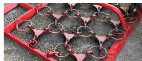
Étoiles avec tiges et pointes, utilisation des deux côtés
