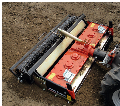
Réglage de manière continue de la profondeur de travail à l'aide d'une tige
