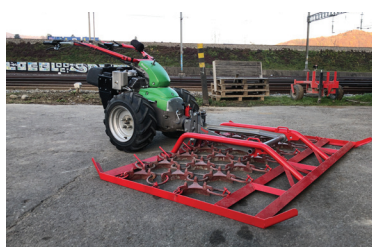
Accessoire trainé Grâce à la conception structurelle de la herse de prairie, il est facile de travailler en marche avant.
